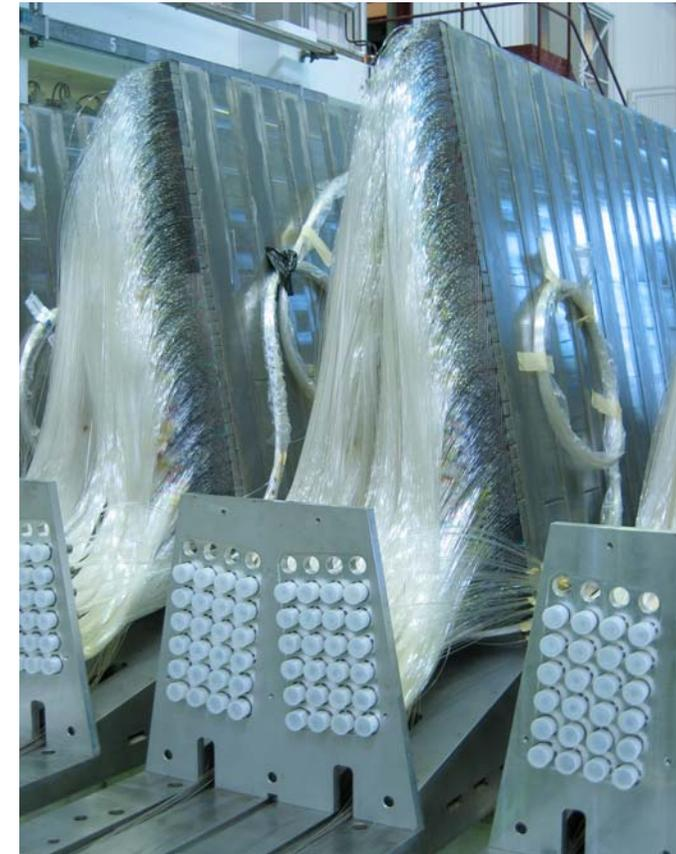
**In den beiden Vorwärtsregionen wird die Kalorimetrie durch das Forward HCAL komplettiert. Es besteht aus Absorberplatten aus Stahl und strahlungsresistente Quarzfasern. Die Auslesung erfolgt durch konventionelle Photoelektronenvervielfacher, da die magnetische Flussdichte viel kleiner als im zentralen Bereich ist.**
